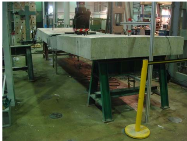
Foto 4. Estado de pre-rotura de la losa.
